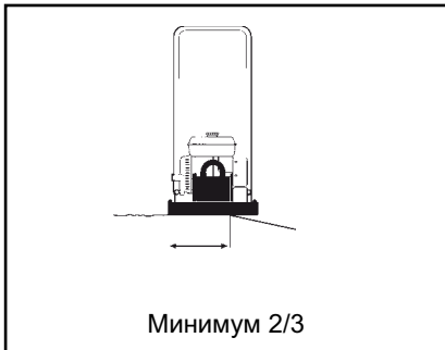
Положение машины при работе на кромках
